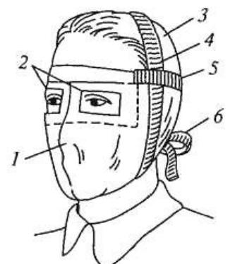
Рис. 5.15. Противопыльная тканевая маска ПТМ-1:
