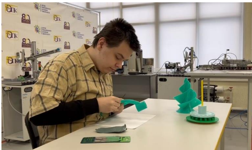
Рисунок 9 – Процесс обработки базовой части устройства и начальный этап сборки ветрогенератора.
