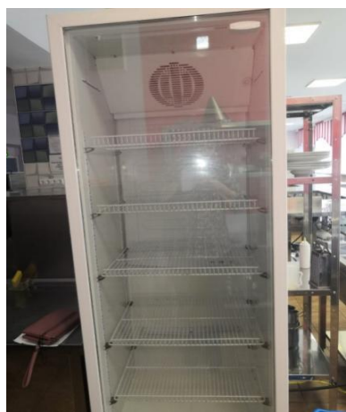
Рисунок 7. Шкаф холодильный Бирюса 460N. Объем 455 л. Потребляемая мощность 0,205 кВт*ч
