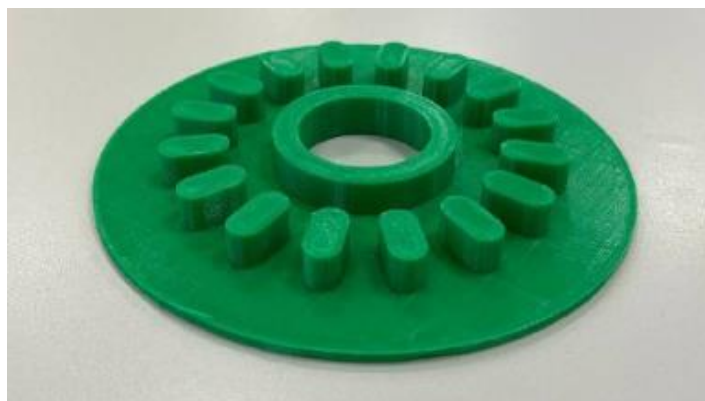
Рисунок 8 – Форма для намотки медной змеевидной катушки
