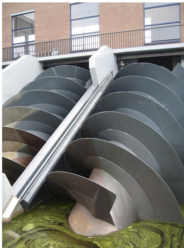
Рисунок 3 – Современные архимедовы винты, используемые для осушения полей в Голландии.
