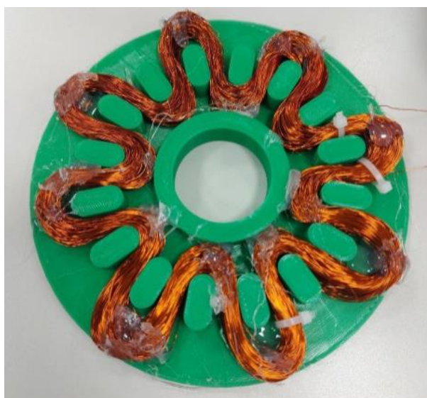
Рисунок 10 – Генератор с осевым потоком без железного сердечника в обмотке
