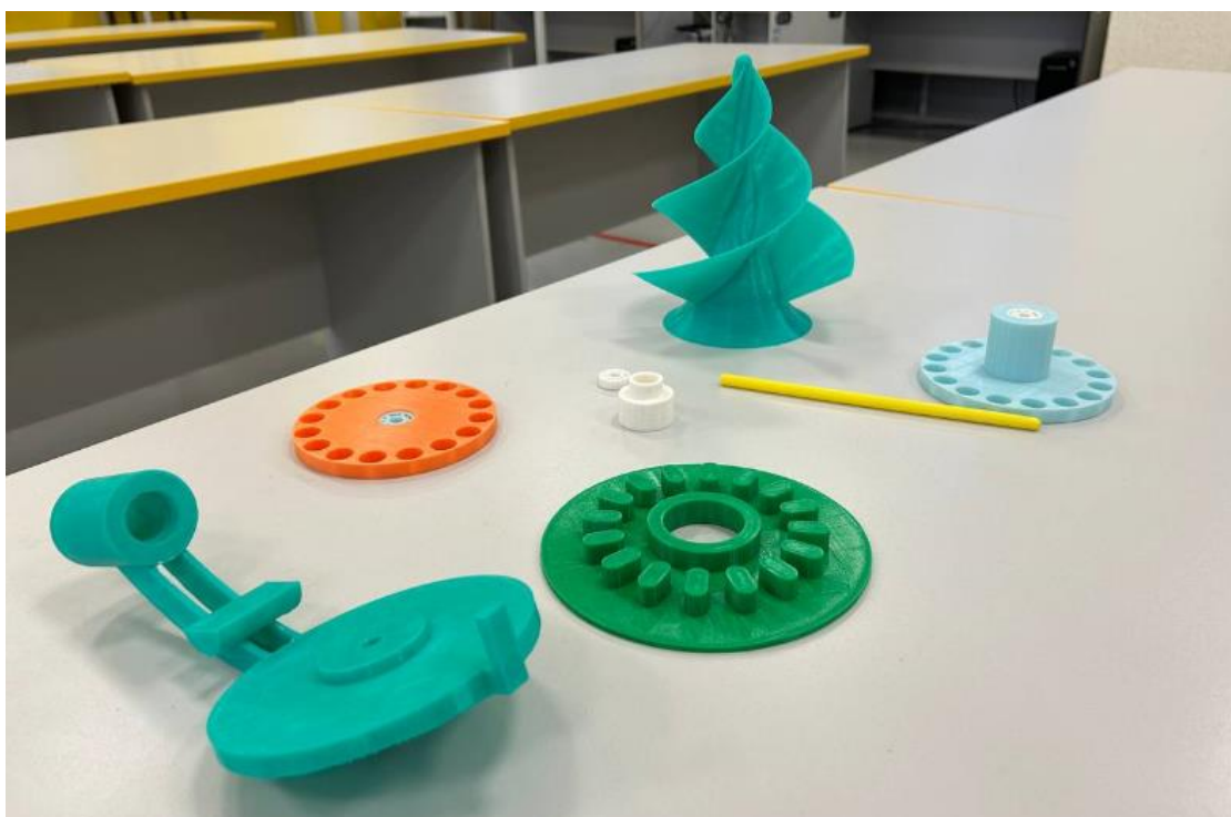
Рисунок 4 – Детали ветрогенератора, изготовленные методом FDM печати
